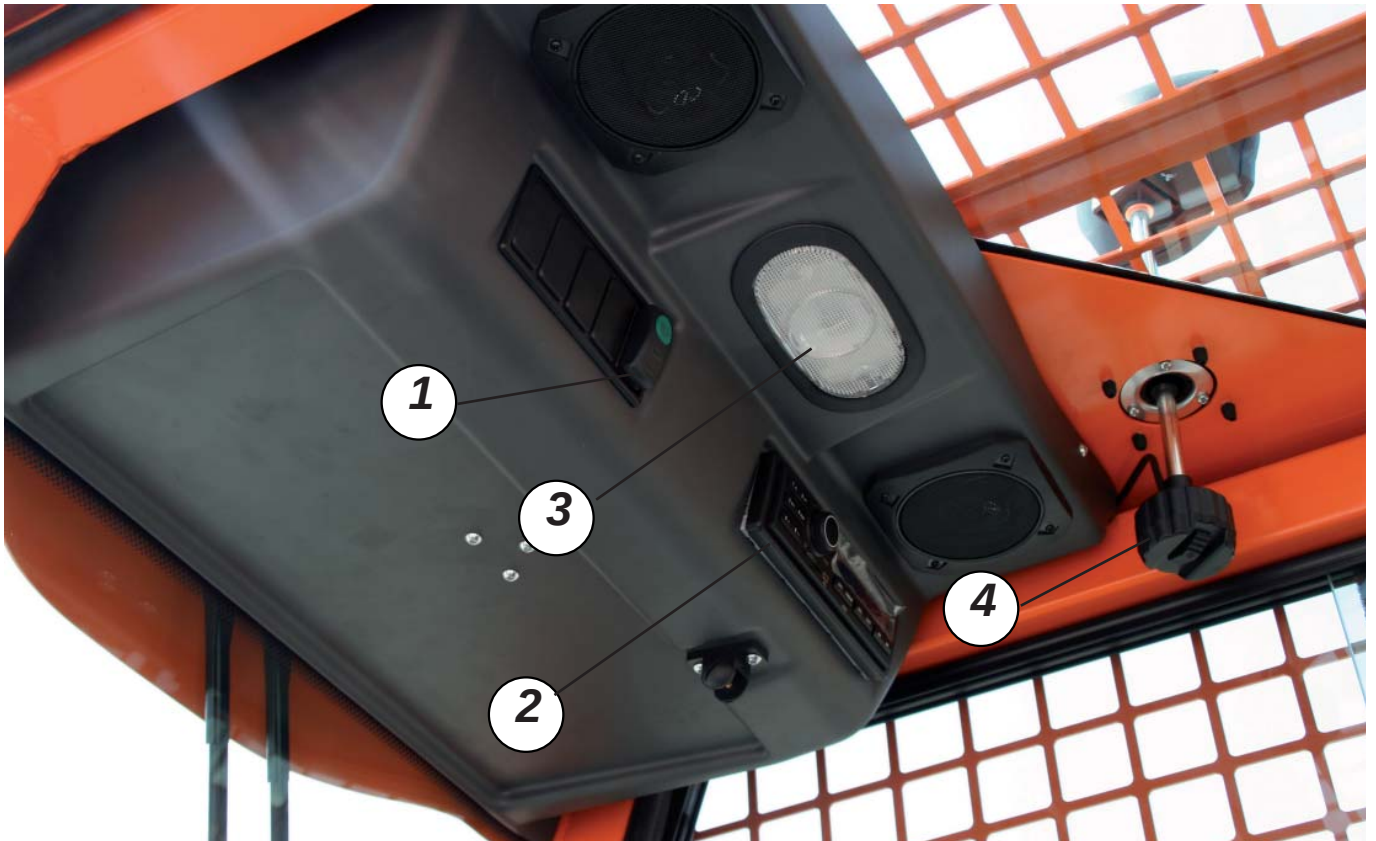
Fig.5.10 - Interrupteurs du toit et leviers
